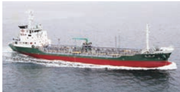
船名 明和丸 L・D・B 64.98・4.50・10.00 区域 沿海 総トン数 499.00 船籍 東京 D / W 1250.28 (996.092)
