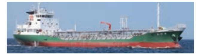
船名 美和丸 L・D・B 64.49・4.50・10.00 区域 沿海 総トン数 498.00 船籍 丸亀 D / W 1250.00
