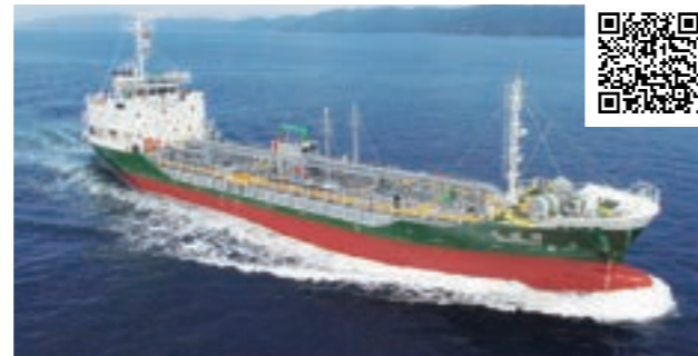
船名 明桜丸 L・D・B 64.94・4.60・10.40 区域 沿海 総トン数 597.00 船籍 東京 D / W 1283.70 (1196/994/848)
