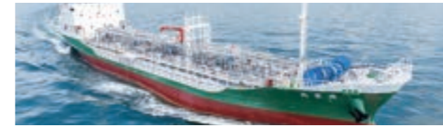
船名 逸愛丸 L・D・B 63.86・4.50・10.00 区域 沿海 総トン数 499.00 船籍 丸亀 D / W 1218.2
